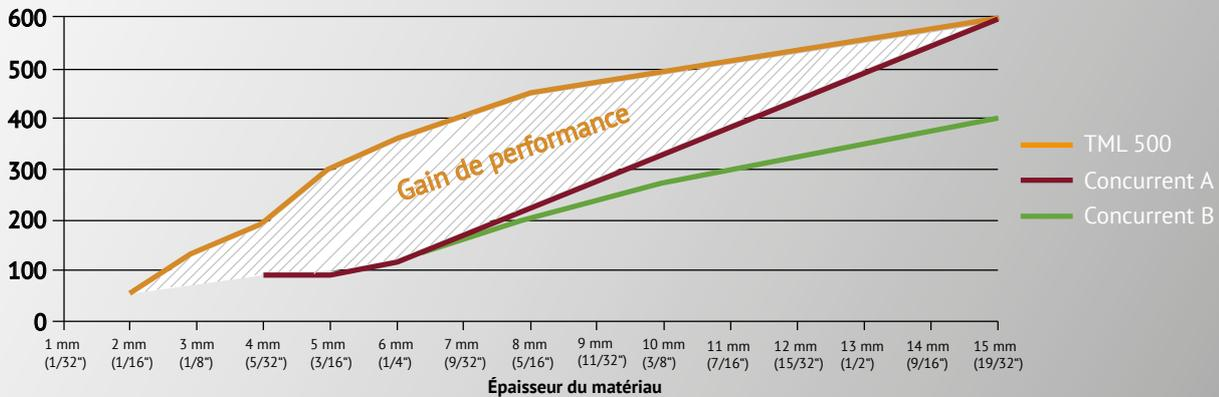
Une comparaison des données de performance du TML 500 et deux aimants conventionnels révèle la puissance du TML 500, notamment pour une utilisation sur les matériaux minces.
